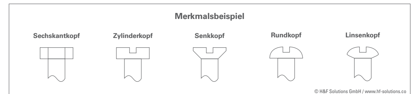
Abb. 2.1.a Merkmal Schraubenkopf in der Klassifizierung, Beispiel von verschiedenen Ausprägungen eines Schraubenkopfs.
